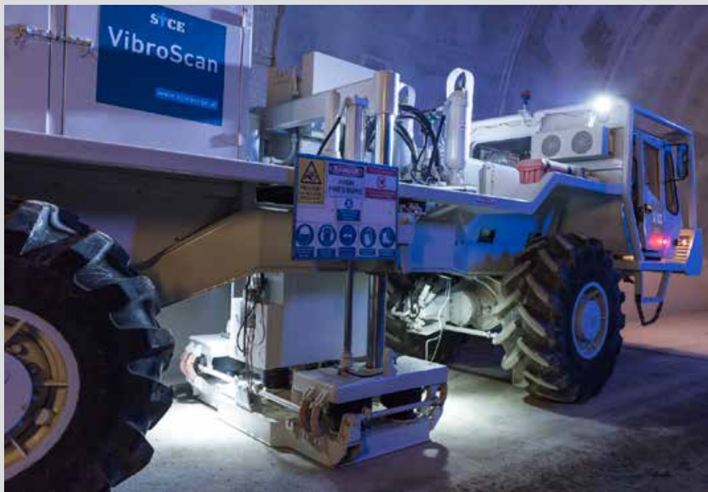
CHAMPEL-HÔPITAL – Le camion vibreur en action dans le tunnel début avril 2017. À l'aide du sabot appuyé sur le sol, il reproduit les vibrations qu'émettrait le passage d'un train.
